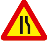
TP-17a ESTRECHAMIENTO DE CALZADA POR LA DERECHA
