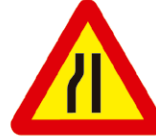
TP-17b ESTRECHAMIENTO DE CALZADA POR LA IZQUIERDA
