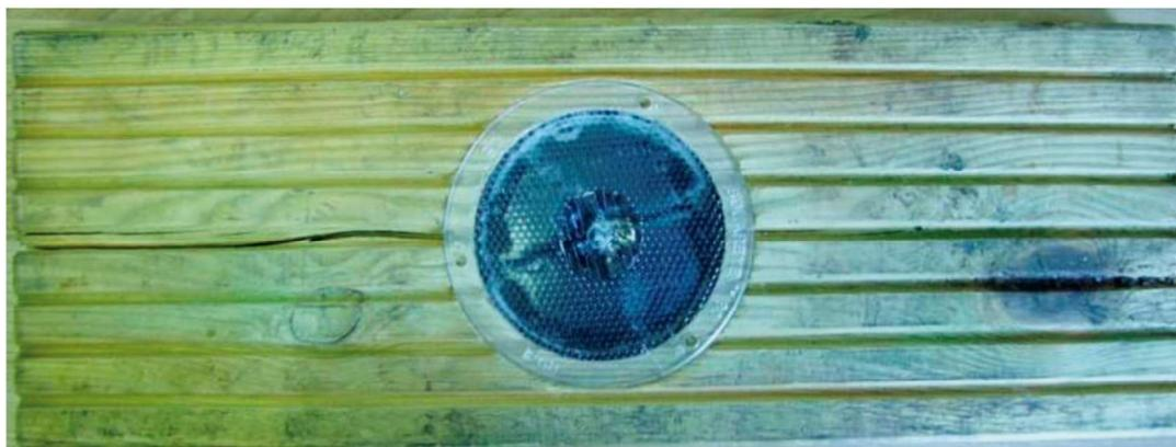
Figura 1. Daño en al producto solareye80 después de una carga de compresión de 600 kN
